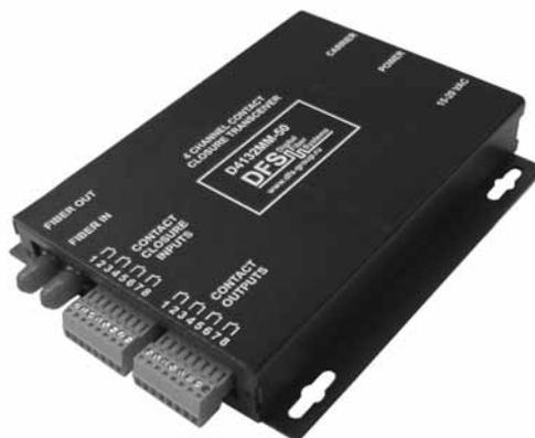
Приемопередатчики DFS серии D4132MM / D4132SM обеспечивают одновременную передачу и прием 4 сухих контактов по двум (одному) оптическим волокнам. На модулях D4132MM / D4132SM используются 4 (четыре) гальванически развязанных выходных реле.
