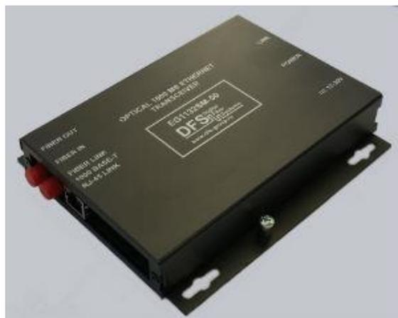
Серия цифровых оптических 1-канальных EG1132 (MM/SM) и EG1131(MM/SM) WDM Ethernet 1Gb приемопередатчиков обеспечивает прием и передачу сигналов 1GB (1000 Mbps) в секунду по 2 (1) оптическим волокнам. Данные приемопередатчики работают в качестве оптической вставки на линии 1Gb. Модули серии могут использоваться как с одномодовыми (SM), так и многомодовыми (MM) оптическими кабелями.
