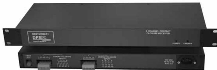
Передатчики и приемники DFS серии DT8131 / DR8131 (MM/SM) обеспечивают передачу и прием 8 сухих контактов по 1 (одному) оптическому волокну. На приемниках DR8131 (MM/SM) используются 8 (восемь) гальванически развязанных выходных реле.
